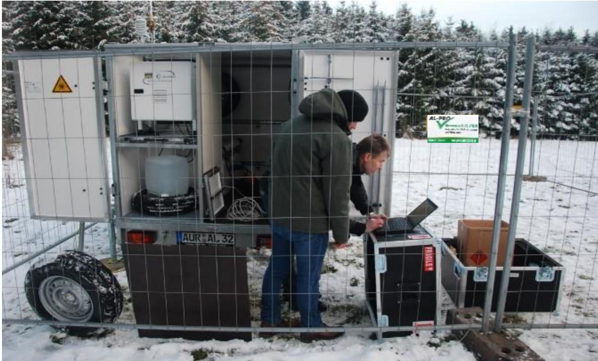
Abbildung 12, LiDAR-Windmessung in Baden-Württemberg
